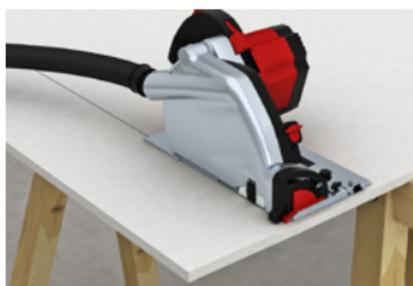
Es empfiehlt sich eine Handkreissäge mit Hartmetallbestückung und geringer Drehzahl sowie einer Absaugung mit Nachlauf. Diamantbestückte Fräseblätter verlängern die Standzeit des Werkzeuges.
